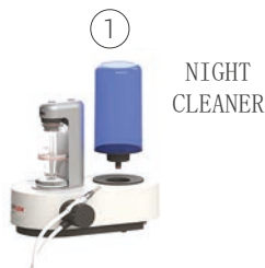
将蓝瓶放到设备上，装满 NIGHT CLEANER
